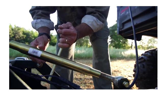
THE "DOWN PRESSURE SYSTEM" IS DESIGNED FOR THE USER TO DISTRIBUTE THE CUTTING PRESSURE OF THE DISC WHERE NEEDED.
