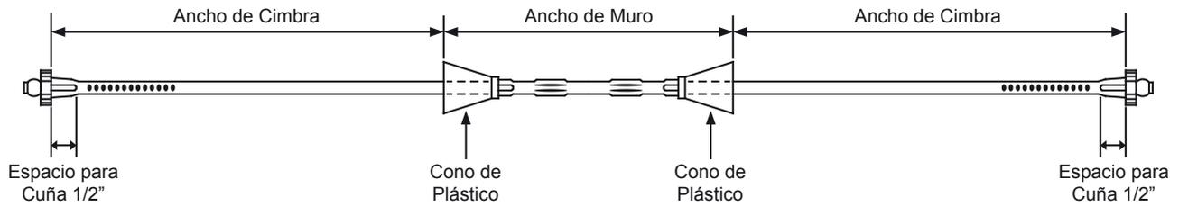
Los tirantes rompibles, son elementos de acero de alto carbón, que sirven para retener las paredes de la cimbra, antes, durante y después del vaciado del concreto.
